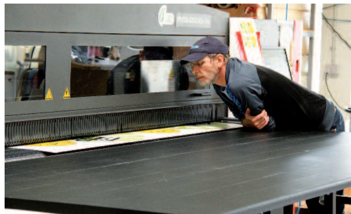
Über den Weißkanal lässt sich eine nahezu unübertreffbare Deckkraft erzielen – und dies bereits nach einem Durchgang.
