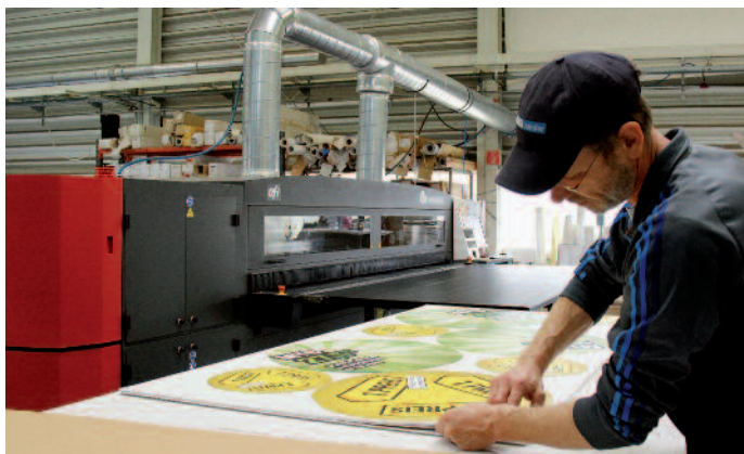
Die Vutek GS3250lx von Efl bietet eine Druckbreite von 3,2 m und die Möglichkeit, sowohl starre als auch flexible Materialien zu verarbeiten.
