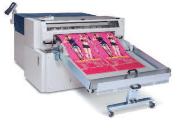
Der Cutter verfügt über eine horizontale und zudem über vier vertikale Klingen, für randlose Druck-Erzeugnisse, im Einfach-, Zweifach- oder Dreifachnutzen. Das System erkennt die eingefügten Schnittmarken auf jedem Druck, richtet diese perfekt aus und justiert gleichzeitig seine Klingen so, dass eine Schnittgenauigkeit von 1 mm ermöglicht wird.
