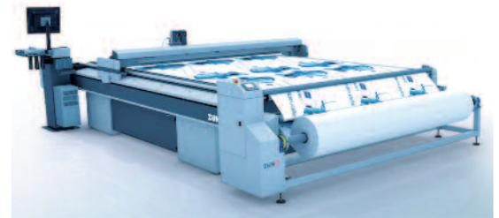
Ausgerüstet mit einem Zentrumschwicker schneidet der Zünd Cutter G3 3XL-1600 Rollenmaterialien bis zu einer Breite von 3,21 m vollautomatisch und wirtschaftlich.
