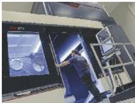
In einem klimatisierten Raum bearbeitet die Hightech-Fräsmaschine DMC 270 (DIXI) Großteile in Uhrmacher-Präzision.
