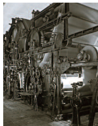
Stand der Technik vor etwa 100 Jahren: eine Papiermaschine im Jahre 1921 mit einer Arbeitsbreite von 2,5 m. (Quelle: Papierfabrik Palm.)
