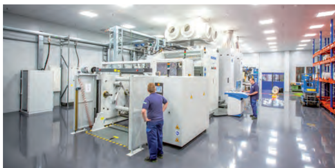
Fassade des Digitaldruckraumes im Interprint-Werk Arnberg: Mit »Hello World!« wird die neue Drucktechnologie begrüßt. Weltpremiere: Mit dieser Anlage von KBA können digital bedruckte Dekorpapiere in Serie produziert werden.
