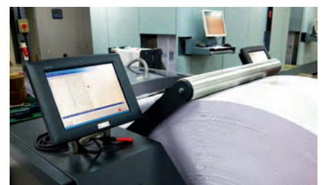
Der Rewinder 555 mit PrePost Manager-Monitor.
