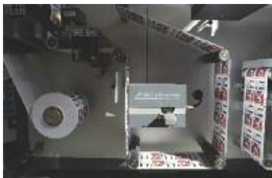
Das PowerScope 4000 ist als Bahnüberwachungsgerät ideal zum Beispiel für den Etikettendruck.
