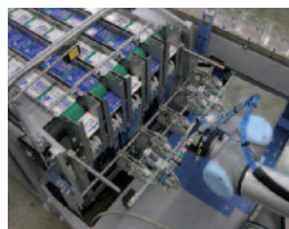
Der Roboter greift die fünf unterschiedlichen Etikettenstapel.
