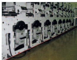
UV-System mit acht UV-Lampen und Stickstoff-Inertisierung auf einer Flexo-Druckmaschine.
