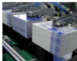
Der Roboter greift die fünf unterschiedlichen Etikettenstapel.
