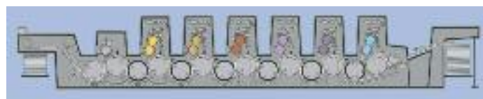
Schema einer Sechsfarbenmaschine mit Lackturm in der damals revolutionären Aggregatbauweise.
