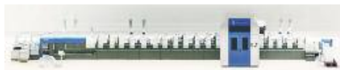
Lange Bogenoffsetmaschinen wie diese 19-Werke-Rapida 106 in der Schweiz sind nur in Aggregatbauweise möglich.
