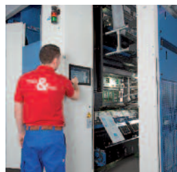
Automatischer Plattenwechsel an der KBA Commander CL in weniger als 3 Minuten.
