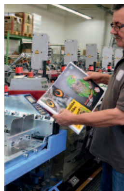
Der neue Falzanleger 0507 kann von Hand (im Bild Zofinger-Tagblatt-Maschinenführer Vajo Krstić) oder mittels Streamfeeder beschickt werden.
