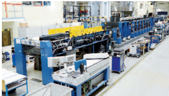
Aktuell steht bei KBA-Sheetfed Solutions in Radebeul eine Rapida 106 mit 18 Druck- und Veredelungswerken für einen großen amerikanischen Kunden in der Montagehalle.
