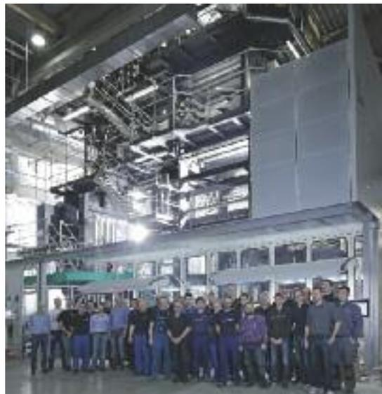
Die WKS Druckholding GmbH mit Standorten in Essen und Wassenberg betreibt bereits acht Lithoman-Anlagen von manroland web systems, darunter auch die grösste Illustrationsmaschine der Welt – eine zweibahnige 80-Seiten-Lithoman mit insgesamt 4,5 m Papierbahnbreite, das entspricht einer 160 Seiten-Maschine.
