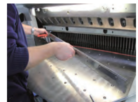
Dienes Vario-Cut beim Einbau.
