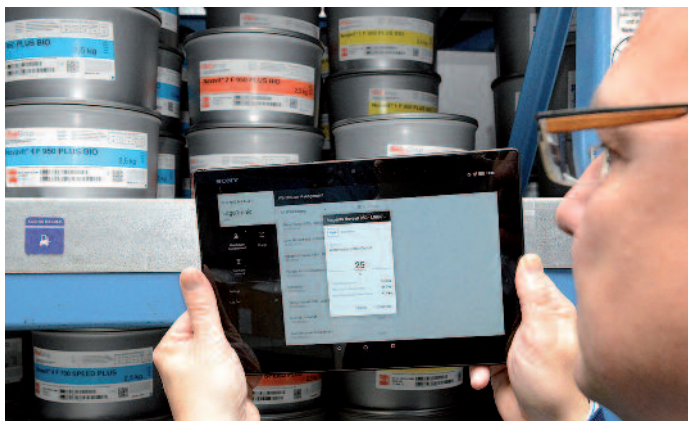
Lagerplatz mit NFC-Tag: Lagerort und Farbmenge werden im Lager mit der ProductionApp erfasst und stehen für die Weiterverfolgung bereit.
