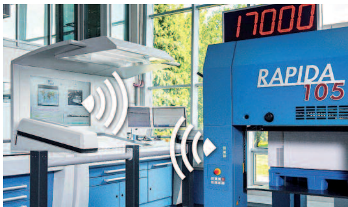
Mit ErgoTronic AutoRun konfigurieren sich Rapida-Bogenoffsetmaschinen selbst, wechseln vollautomatisch die Jobs und produzieren diese ohne manuelle Eingriffe der Bediener.
