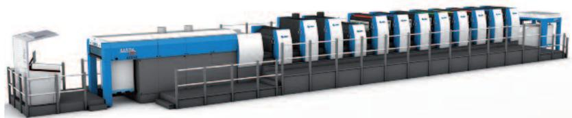
Rapida 106 mit insgesamt 12 High-Tech-Werken (8 Druck-, 2 Lack-, 2 Trockenwerke).
