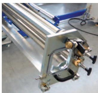
Die MBO T1420P ist serienmässig mit der patentierten Messerwellenkassette ausgestattet.
