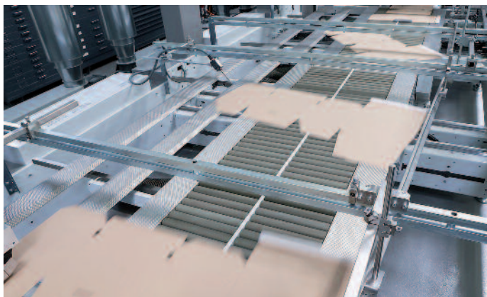
Mit dem Drehmodul Gyrobox XL stellt die Masterfold 230 in einem Arbeitsgang Faltschachteln selbst mit komplexen Konstruktionen her – insbesondere auch Versandverpackungen für den Online-Handel.
