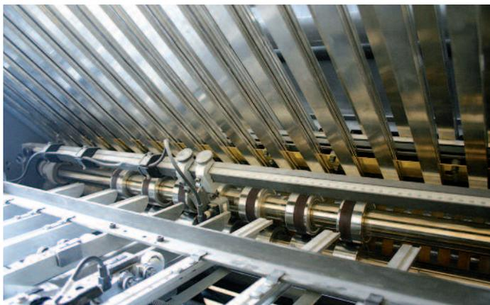
Falzmaschinen sind höchst filigrane Konstruktionen. Doch was auf den ersten Blick nach klassischer Mechanik aussieht, ist längst auch mit Stellmotoren und Elektronik gespickt, um Falzmaschinen in digitale Workflows einbinden zu können.
