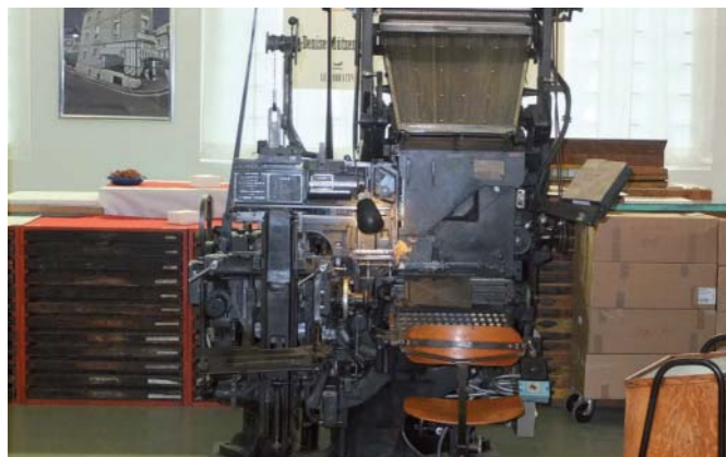
Kaum zu glauben, aber diese Linotype wurde in einer Scheune entdeckt und wieder so hergerichtet, dass sie funktioniert.
