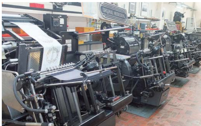
Heidelberger Tiegel in Reih und Glied. Sie werden für das Drucken ebenso genutzt wie für Veredelungen.
