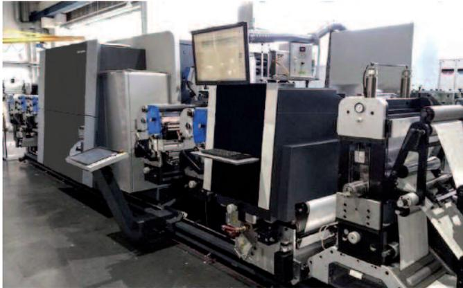
In die Gallus Labelfire ist eine äusserst kompakt gebaute Embellishment-Einheit der Steinemann AG integriert.
