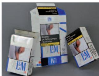
Die Abbildungen und Markenfarben sind digital im erweiterten Farbraum inklusive Weiss gedruckt. Danach wurde ein UV-Silber im Flexodruck gedruckt, gefolgt vom ersten UV-Mattlack, der etwas rauer eingestellt ist und danach der zweite UV-Mattlack. Zum Schluss werden alle L&M Embleme geprägt.
