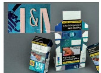
Die Metallic Effekte werden durch online Kaltfolie plus Leimauftrag im Flexowerk erzielt. Die Design-Farben sind im erweiterten Farbraum inklusive Weiss digital gedruckt. Es wurde ein rau eingestellter Mattlack eingesetzt und im letzten Schritt die Markenelemente zusätzlich geprägt.
