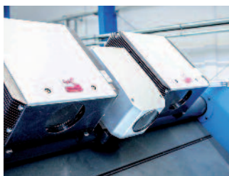
Zwei Kameras inspizieren die Druckbogen bis zur maximalen Maschinenleistung. Sie erkennen kleinste Differenzen im Vergleich zur Referenz, die anhand des Vorstufen-PDFs erstellt wurde.
