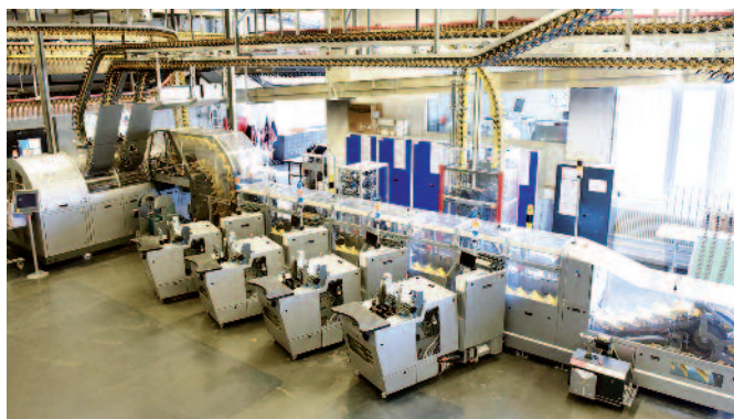
Eine Zusammentraganlage FlyStream mit vier JetFeedern sowie eine Einstecktrommel mit zwei Zuführungen erlaubt das Komplettieren der Zeitungen durch Beilagen und Vorprodukte.
