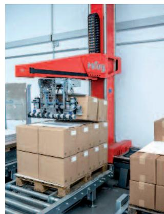
*Ein Palettierroboter verschliesst, etikettiert, palettiert und transportiert die verpackten Ware.*
