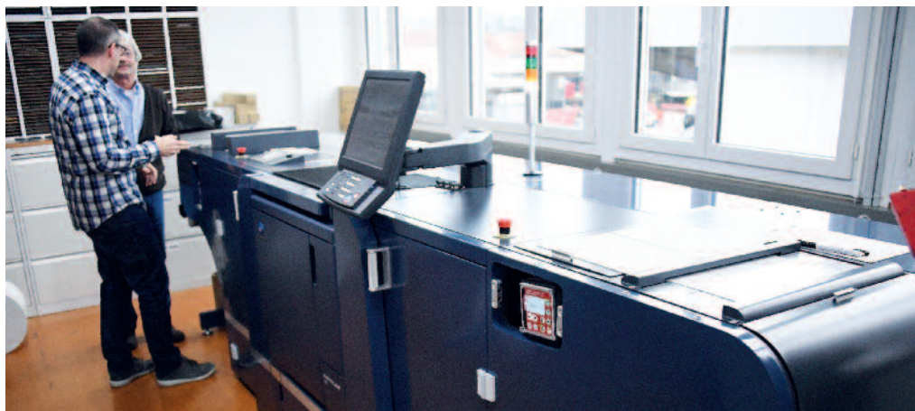
Die AccurioLabel 230 ist äusserst kompakt und vielseitig. Es sind aber keine speziellen Medien erforderlich und auch keine Vorbehandlung der Medien.
