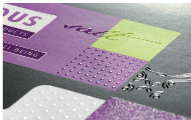
Druckmuster der Digitale Embellishment Unit (DEU) der Steinemann DPE mit grossflächigen Spotlackierungen, Spotlackierung mit Darstellung feiner Elemente und Simulation eines Drip-off-Effekts im Spotlack. (Bildquelle: Steinemann DPE .)
