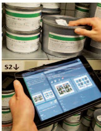
Mit der neuen Press Center Mobile App kann der Bediener von allen angeschlossenen Maschinen auf einem Tablet oder Smartphone alle wichtigen Leitstandinformationen, wie den aktuellen Auftragsstatus, die Job Queue mit der Wechselübersicht sowie den Status der Verbrauchsmittel abrufen.
