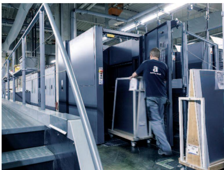
Plate-to-Gallery bei Aumüller nutzt die hoch automatisierte CtP-Produktion, bei der die Platten mit einem Code versehen und von einem Roboter vom Ausgabeband des CtP-Systems auf einen bereitstehenden Transportwagen mit RFID-Chip gestellt werden. Der voll bestückte Plattenwagen mit einem Gewicht von etwa 30 kg wird via Scan verifiziert und mit einem Lift auf die verbreiterte Galerie der Speedmaster 2020 gefahren.
