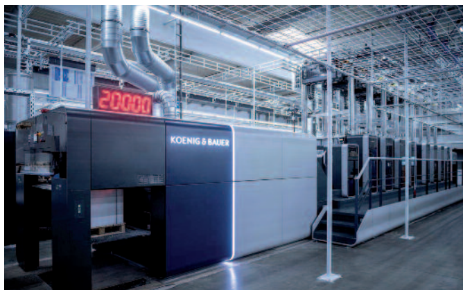
Typische Akzidenzmaschine: Rapida 106 X als Achtfarbenmaschine mit Bogenwendung für den 4-über-4-Druck und zusätzlichem Lackturm.
