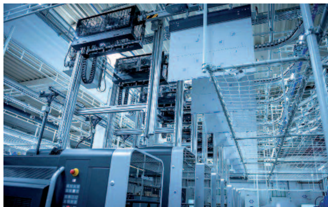
Neu: PlateTronic -Plattenlogistik bis in die Schächte der Plattenwechsler hinein. Vom Plattenbelichter über die Plattenspeicher bis hin zum Plattenwechsler laufen alle Prozesse vollautomatisch ab.
