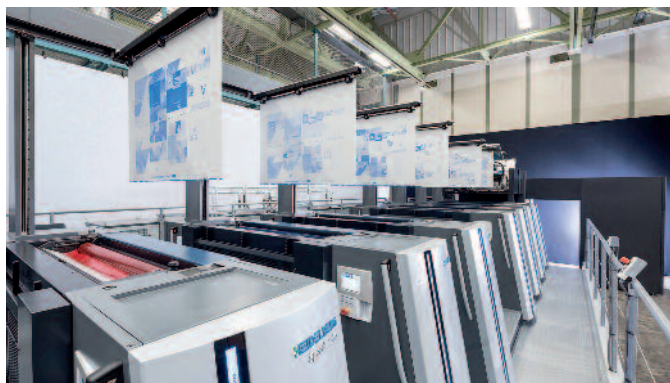
Mit Plate to Unit, der neuen vollautomatischen Druckplattenlogistik an der Druckmaschine, erfolgt die Bereitstellung der Druckplatten und deren Entsorgung komplett automatisiert.
