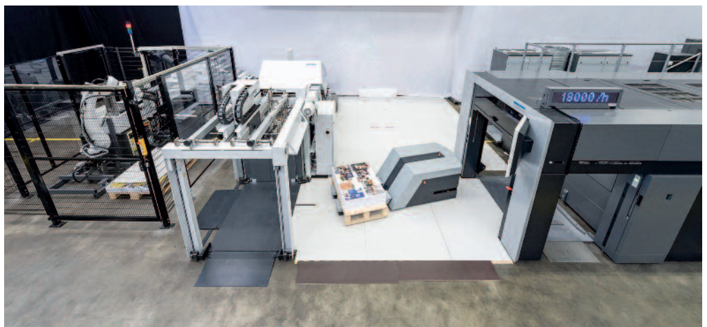
Mit einem bedienerlosen Transportsystem wird der fertig gedruckte Bogenstapel an die Falzmaschine Stahlfolder KH 82-P gefahren. Diese ist ebenfalls über das Push-to-Stop-Konzept integriert und erkennt die nächste Signatur automatisch am mitgedruckten Barcode.
