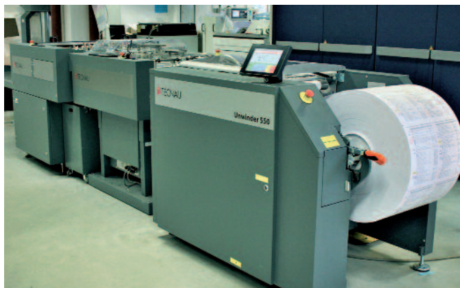
Die Tecna Cut & Stack-Linie besteht aus einer UW 550 Abrollung, einem TC 7000 Schneidemodul, einem TC 1220 Stapler und einem Auslageband.
