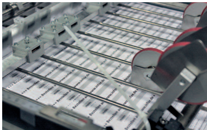
Geschchnittene Drucke verlassen das Schneidemodul im Schuppenstrom.
