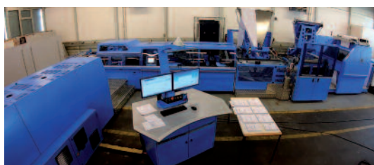
Die SigmaLine III bietet neu die Möglichkeit, zweimal hintereinander zu schneiden. So kann bei Bedarf der Querfalz umgangen werden.
