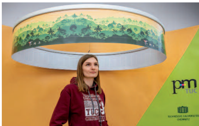
Gedruckte Lautsprecher erzeugen überraschende Urwald-Illusion: Die in eine Papierbahn eingebettete gedruckte Elektronik ermöglicht einen 360°-Surround-Sound. Varvara Bachul vom Institut für Print- und Medientechnik der TU Chemnitz analysiert den Soundverlauf, der innerhalb des T-Rings erzeugt wird. Die Töne kommen aus 56 gedruckten Einzellautsprechern, die auf der knapp vier Meter lange Kreisbahn zu sieben Segmenten verbunden sind.
