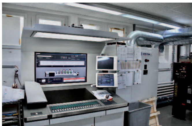
Alles vollautomatisch: Platteneinzug, kameraüberwachte Farbregelung, Passer und Register. An der Maschine lösen sich jeweils zwei Drucker in 100-Prozent-Pensum ab sowie ein Lernender, der die Prüfung auf dieser Maschine absolvieren wird.
