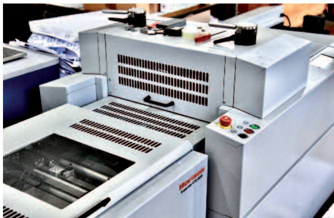
Rotative Stanz- und Rillmaschine von Horizon, Stanzform aus Blech von Kocher & Beck: Schneller und wirtschaftlicher stanzen und rillen als im Buchdruck.
