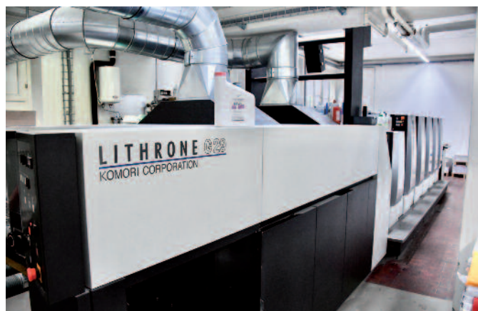
Alles vollautomatisch: Platteneinzug, kameraüberwachte Farbregelung, Passer und Register. An der Maschine lösen sich jeweils zwei Drucker in 100-Prozent-Pensum ab sowie ein Lernender, der die Prüfung auf dieser Maschine absolvieren wird.
