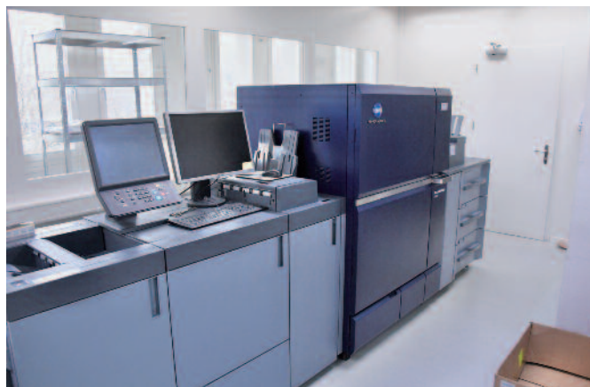
Die Digitaldruckmaschine von Konica Minolta bietet eine Druckleistung bis zu 4.500 A3-Bögen/Stunde. Grammaturbereich: 52 g/m² bis 450 g/m².
