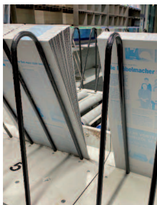
Fertig verarbeitete, abgekanetete und sortierte Kodak Libra VP2 Platten warten auf ihren Einsatz in der Zeitungsrotation.
