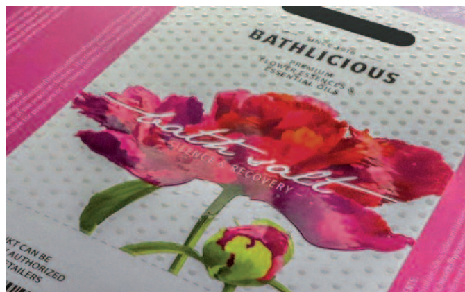
Badesalz-Faltschachtel «Bathlicious» bedruckt im UV-Inkjetdruck. Die digitale Veredelung erfolgte inline mit 32 g/m 2 haptischem UV-Glanzlack in der Digital Embellishment Unit.
