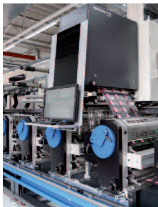
Digital Printbar «White Edition» der Steinemann DPE integriert in eine Gallus Labelmaster 440.
