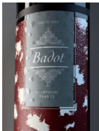
Wodka-Etikett (links) gedruckt im 8-Farben UV-Inkjetdruck und haptischer digitaler Lackauftrag bis 100 g/m 2 , inline mit Kaltfolienapplikation für den Metall-Relief-Effekt (Digital Metallic Doming). Champagner- (Mitte) und Weinetikett bedruckt im 8-Farben UV-Inkjetdruck, danach laminiert mit Mattfolie. Inline digitale Veredelung mit 32 g/m 2 haptischem Glanzlack in der Digital Embellishment Unit.
