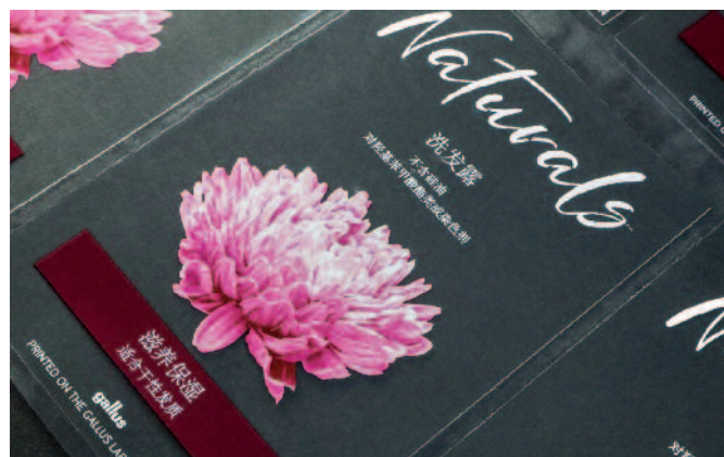
Beim Etikett «Naturals» werden die variablen regionalen Texte mit der Digital Printbar eingedruckt.
