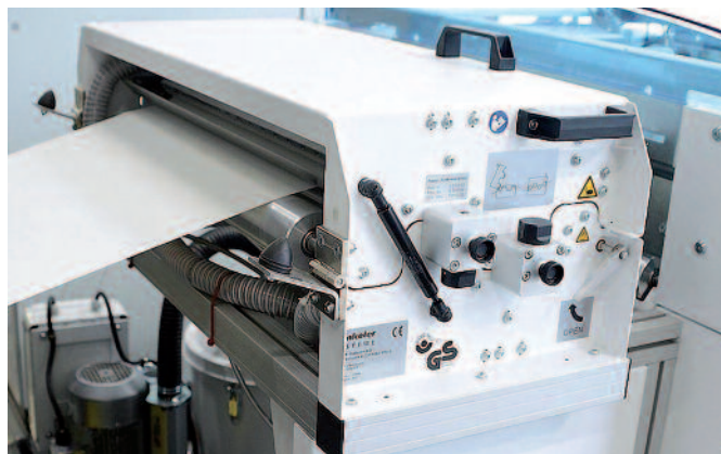
Die Papierentstaubung vermeidet verstopfte Druckköpfe und garantiert so erstklassige Druckergebnisse auf Werkdruck-, Offset-, Bilderdruck- sowie Dünndruckpapieren.
