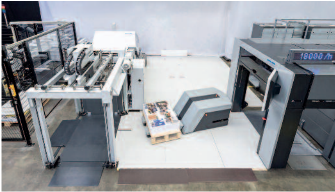
Eine weitere Automatisierungs-Option: Mit einem bedienerlosen Transportsystem wird der fertig gedruckte Bogenstapel an die Falzmaschine Stahlfolder KH 82-P gefahren. Diese ist ebenfalls über das Push-to-Stop-Konzept integriert und erkennt die nächste Signatur automatisch am mitgedruckten Barcode.
