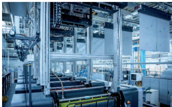
laufen die Platten nach vorgesehener Druckreihenfolge zur *Rapida 106 X*. Hier der Plattensatz in Bereitschaft für den Wechsel.
