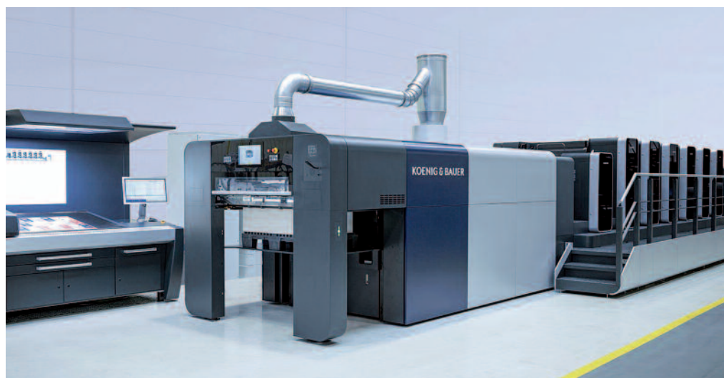
Eine Sechsfarben-Rapida 105 mit Lackturm und Auslageverlängerung wie diese stellte auf der China Print ihre Leistungsfähigkeit im Rahmen von Live-Demonstrationen unter Beweis.
