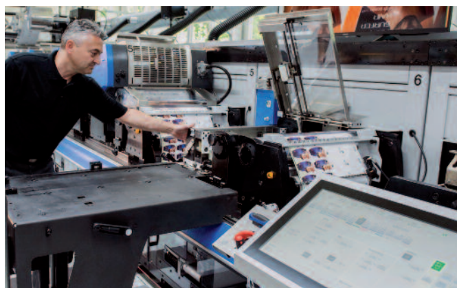
Der Austausch von Druckwerken lässt sich innerhalb weniger Minuten durchführen.
