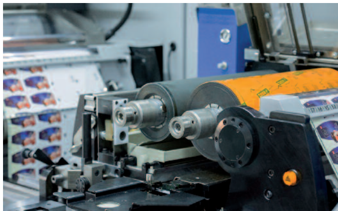
Das ausserhalb der Maschine vorbereitete Flexodruckwerk wird für den Lackauftrag in der Maschine positioniert.
