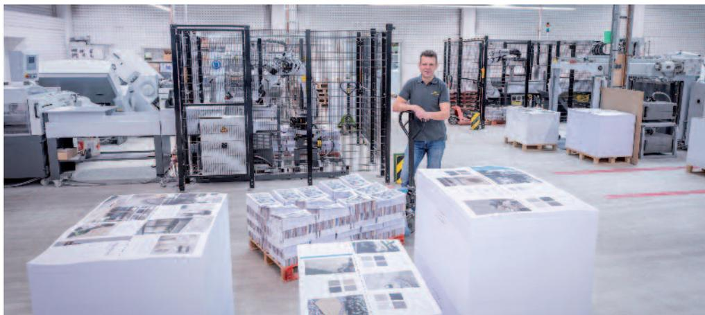
Für den Push-to-Stop-Betrieb werden dem System die vielen Signaturenwechsel über einen mitgedruckten Barcode gemeldet, den eine Kamera im Anleger der Falzmaschine liest. Dabei wird mit bis zu 18.000 Bogen pro Stunde gefalzt, auf Augenhöhe mit dem Bogenoffset. «Durch den Wegfall der körperlichen Tätigkeit sind die Maschinenbediener bereit, die Leistung der Falzmaschine je nach Falzsubjekt und Papierqualität maximal auszufahren», stellt VOLKER DOLLINGER fest.
