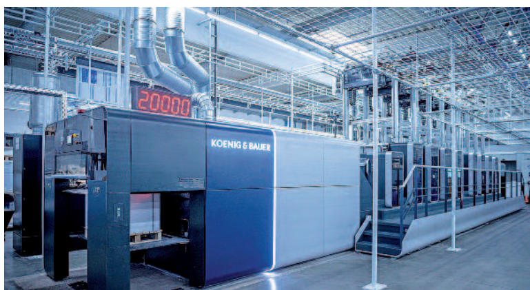
Eine Achtfarben-Rapida 106 X mit Wendung für die 4-über-4-Produktion, zusätzlichem Lackturm und PlateTronic Plattenlogistik ist das neue Herzstück im Drucksaal von Krüger Druck+Verlag .
