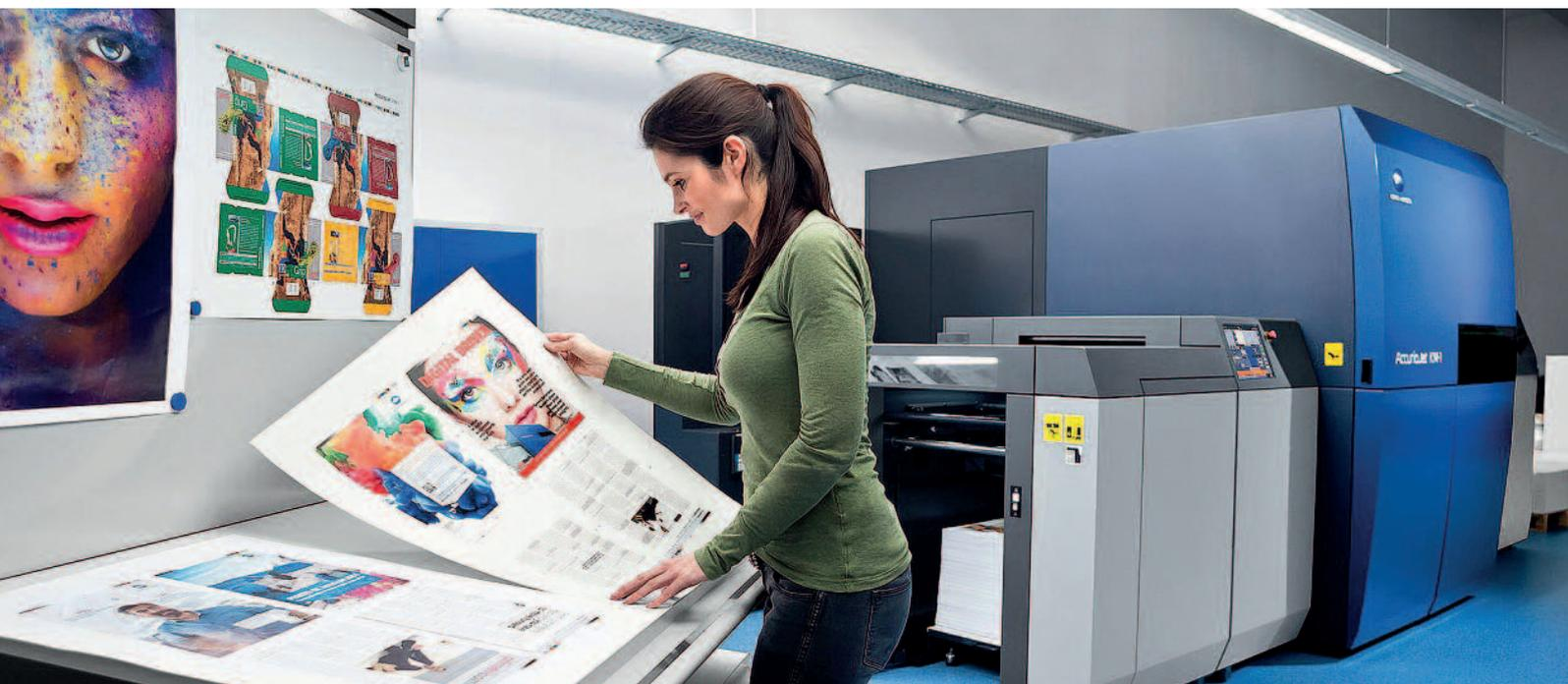
Mit B2-Maschinen wie der AccurioJet KM-1 von Konica Minolta, lassen sich vielfältige Akzidenzen wie etwa Magazine (im Bild) drucken. Mit 3.000 Bogen im 4/0-Modus und 1.500 Bogen im Schön- und Widerdruck bei einer maximalen Bogen-grösse von 585 x 750 mm gehört die KM-1 zu den leistungsfähigsten ihrer Art. Darüber hinaus hat die Maschine den Vorteil mit UV-Inkjet zu arbeiten und ist daher in der Lage, auch wärmeempfindliche Materialien zu verarbeiten.
