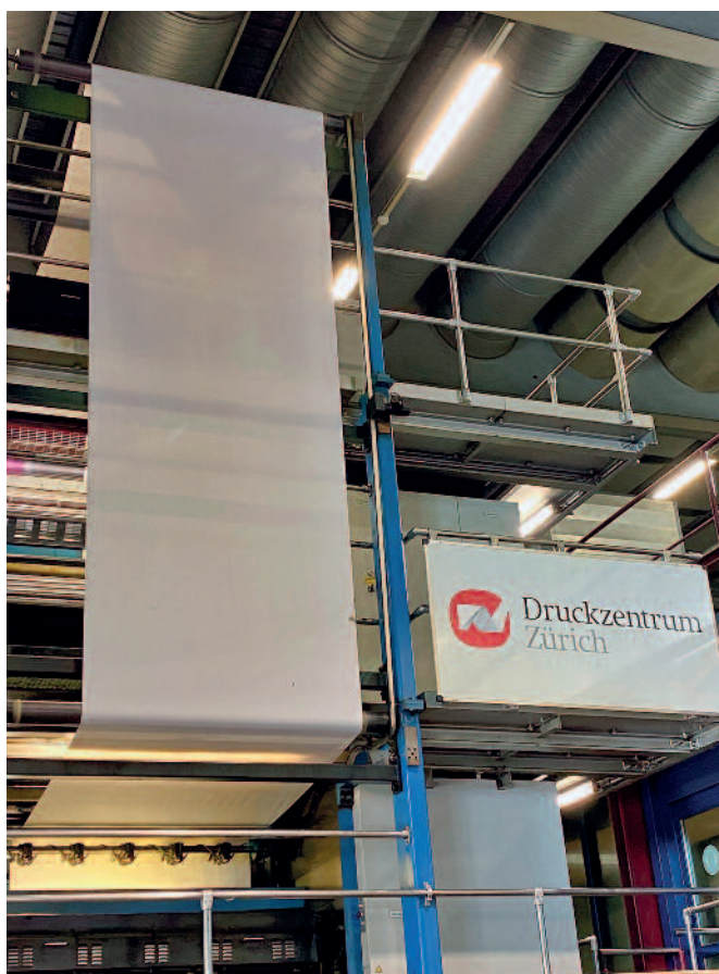
Das DZZ Druckzentrum Zürich produziert auf einer Offsetrotationsanlage, die aus fünf 72-Seiten-Maschinen besteht.
