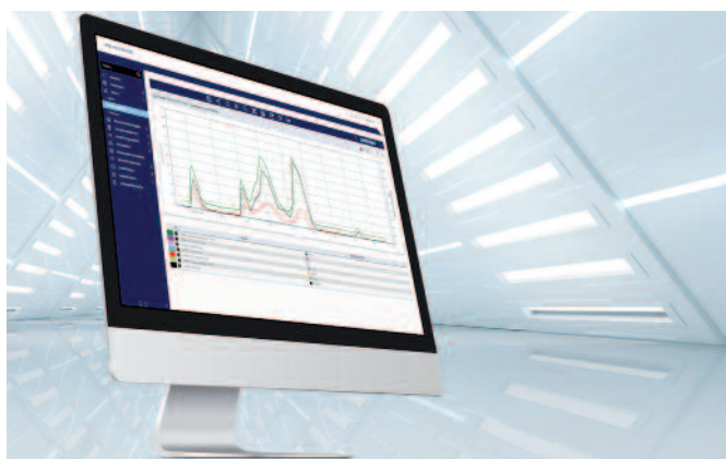
Mit der Software VisuEnergy X kann der Energiebedarf der einzelnen Verbraucher erfasst und visualisiert werden. Das Energiemanagement von Koenig & Bauer umfasst drei Produktbestandteile: die automatisierte Erfassung von Daten, die Visualisierung der Ergebnisse sowie daraus abgeleitete Massnahmen.
