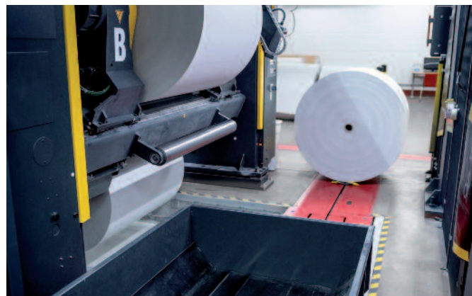
Bewährt und zuverlässig: Patras Rollenhandling für Zeitungsrotationen, etwa bei einer Commander CL .
