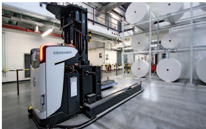
Die Beschickung der Ab- und Aufwickler und der Transport mit Automated Guided Vehicle ist die ideale Lösung für die hochautomatisierte Druckmaschine.
