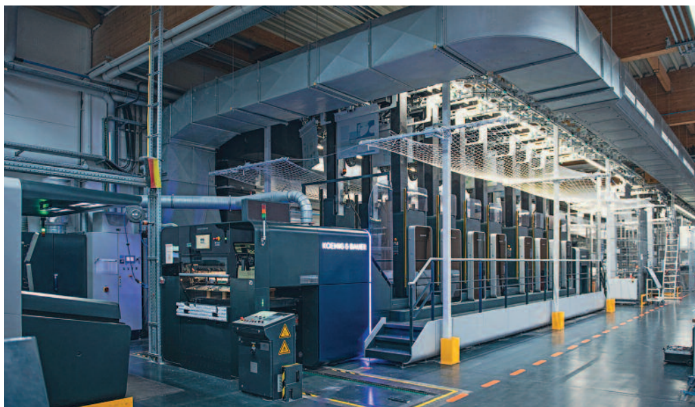
Immer mehr Bogenoffsetmaschinen wie diese Achtfarben-Rapida 106 X mit Bogenwendung für die 4-über-4-Produktion werden in modulare Plattenlogistiksysteme eingebunden
