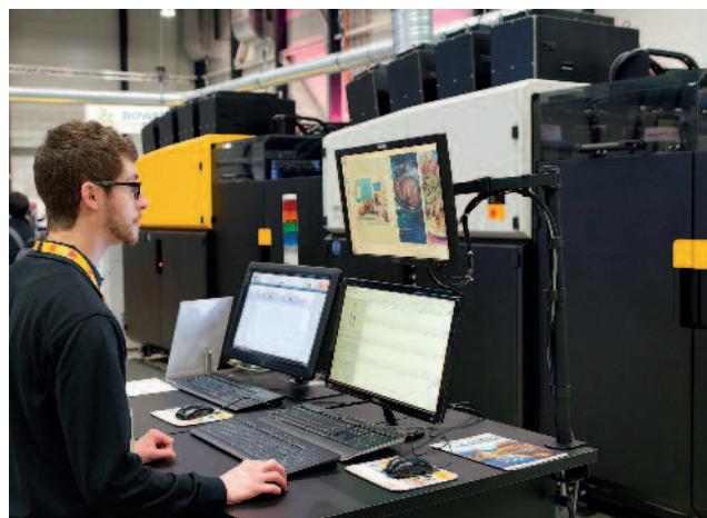
Der Arbeitsplatz des Bedieners am Digital Front End der Kodak Prosper Ultra 520 während der Innovationdays in Luzern.
