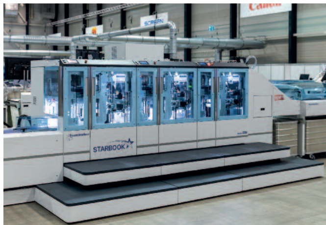
Die Hunkeler Starbook -Lösungen produzieren bis zu 2.000 Buchblocks in der Stunde.
