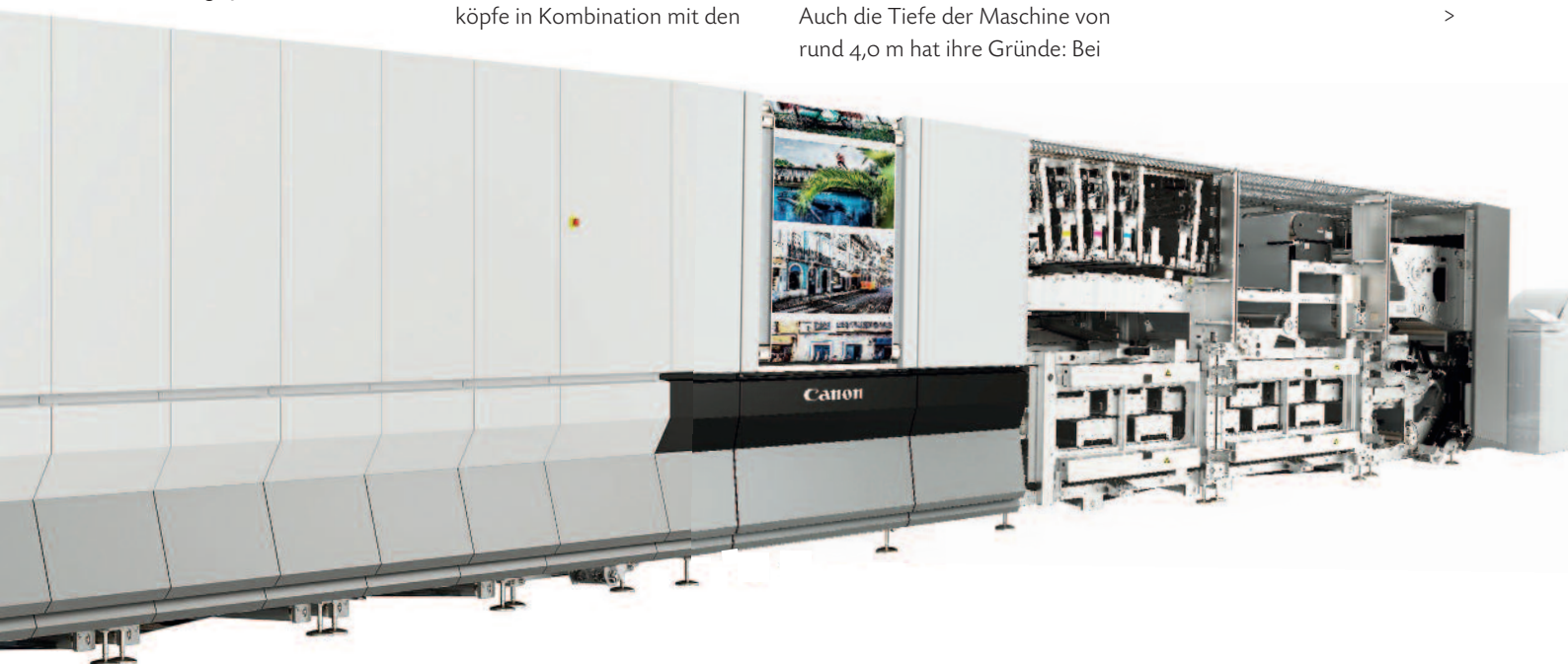
In Luzern produzierte die ProStream 3000 live am Canon -Stand eine Zeitschrift auf Sappi Magno Plus Gloss 150 g/m 2 mit einer Geschwindigkeit von 133 m/Min. Als zweite Liveproduktion wurden Postkarten auf Sappi Magno Satin 250 g/m 2 gedruckt. Bei dieser Grammatur wird die Maschine allerdings nur mit 80 m/Min. gefahren.
