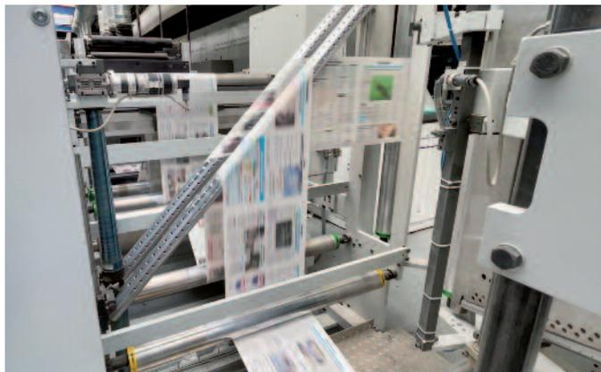
Die Prosper 6000C ist im Schnitt elf Stunden pro Tag im Einsatz, wobei sie mit einer Geschwindigkeit von 280 m/Min. bei 600 x 600 dpi Auflösung betrieben wird.
