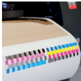
Die Grossformatdrucker bei Wikon Druck arbeiten mit Pigmentfarben und werden für die optimale Farbwiedergabe mit den Testformen von Manfred Dubach (aus Platzgründen haben wir nur eine abgebildet) und weiteren Elementen (Abbildung links) kalibriert.
